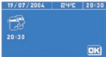
Pantalla de alarma de intrusión
