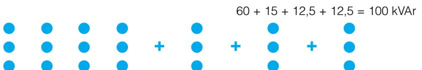
Fig. E6-002: diagrama de diferentes ensamblajes de condensadores para la obtención de potencias superiores.
