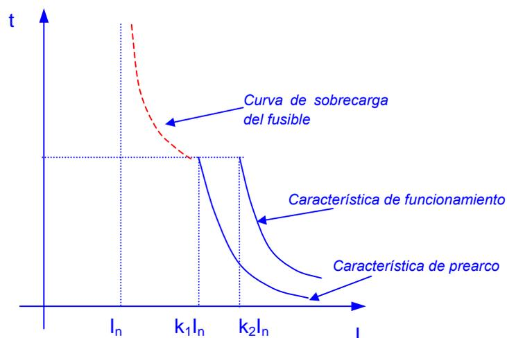
Figura C: Características tiempo-corriente de un cartucho fusible tipo "a"
