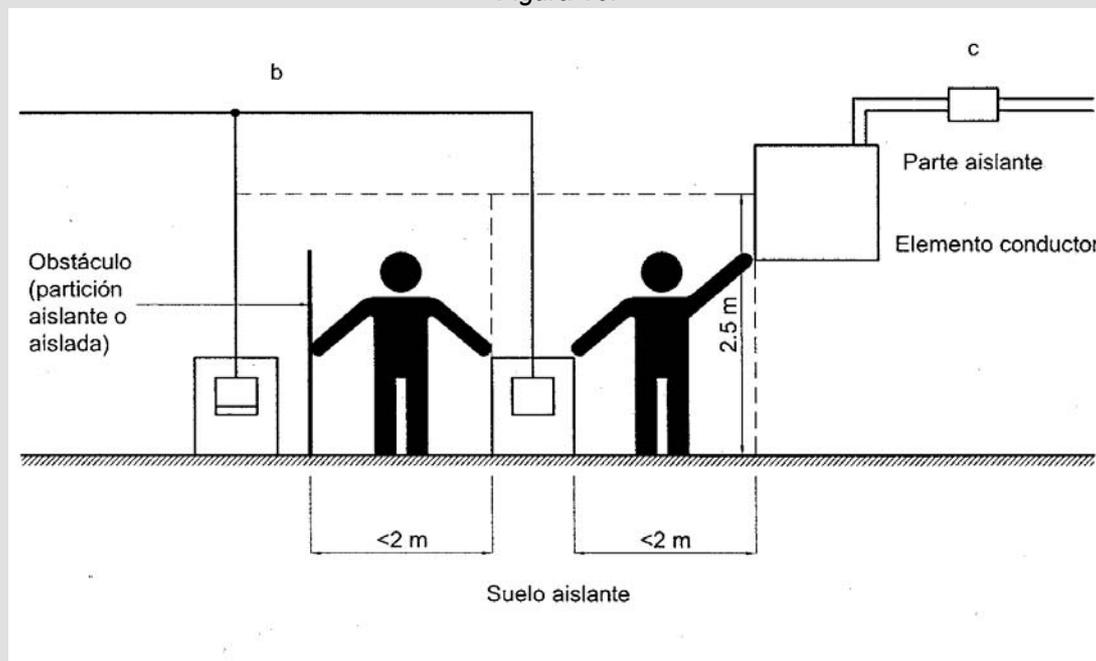
Las paredes y suelos aislantes deben presentar una resistencia no inferior a:
