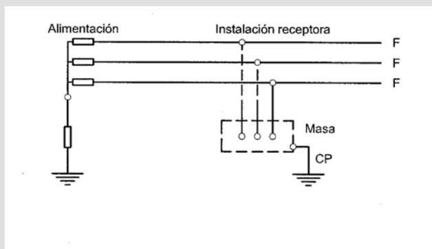
En este esquema la intensidad resultante de un primer defecto fase-masa o fase-tierra, tiene un valor lo suficientemente reducido como para no provocar la aparición de tensiones de contacto peligrosas.
