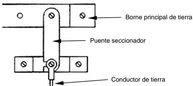
*La sección del puente seccionador de tierra debe ser la misma que la del conductor de tierra o sección equivalente si se utilizan otros materiales.*
