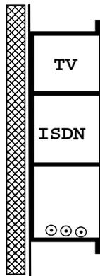
*Figura A. Instalación eléctrica, telecomunicación y datos en un canal con separadores.
