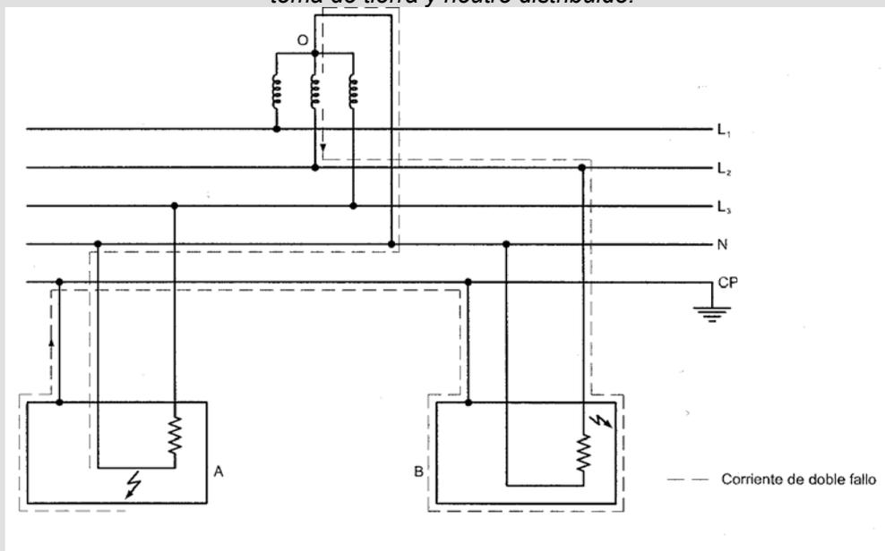
Si no es posible utilizar dispositivos de protección contra sobrecorrientes de forma que se cumpla lo anterior, se utilizarán dispositivos de protección de corriente diferencial-residual para cada aparato de utilización o se realizará una conexión equipotencial complementaria según lo dispuesto en la norma UNE 20.460-4-41
