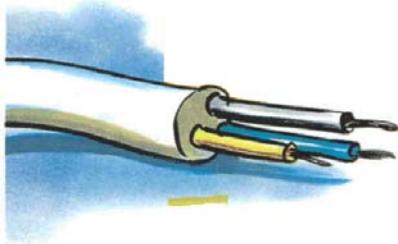
**14** Cuando un receptor ( electrodoméstico, maquinaria, etc ) le dé "calambre" es porque hay derivación de corriente de los hilos conductores o en algún elemento metálico del electrodoméstico. Normalmente se Dispara el Diferencial. Localizar el aparato o parte de la instalación donde se produce y aislar debidamente al
