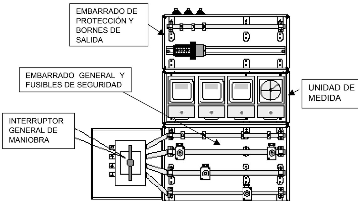
Figura C: Ejemplo de instalación de las unidades funcionales principales de una centralización de contadores.
