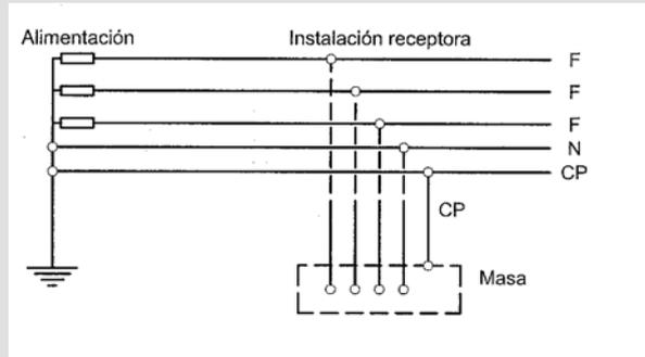
Esquema TN-C: En el que las funciones de neutro y protección están combinados en un solo conductor en todo el esquema (figura 2).
