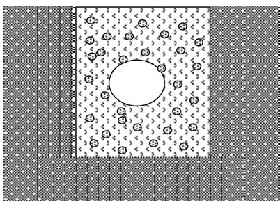
*c) Tubo sin recubrimiento en terreno pedregoso, resistencia a la compresión mínima 750 N.*
