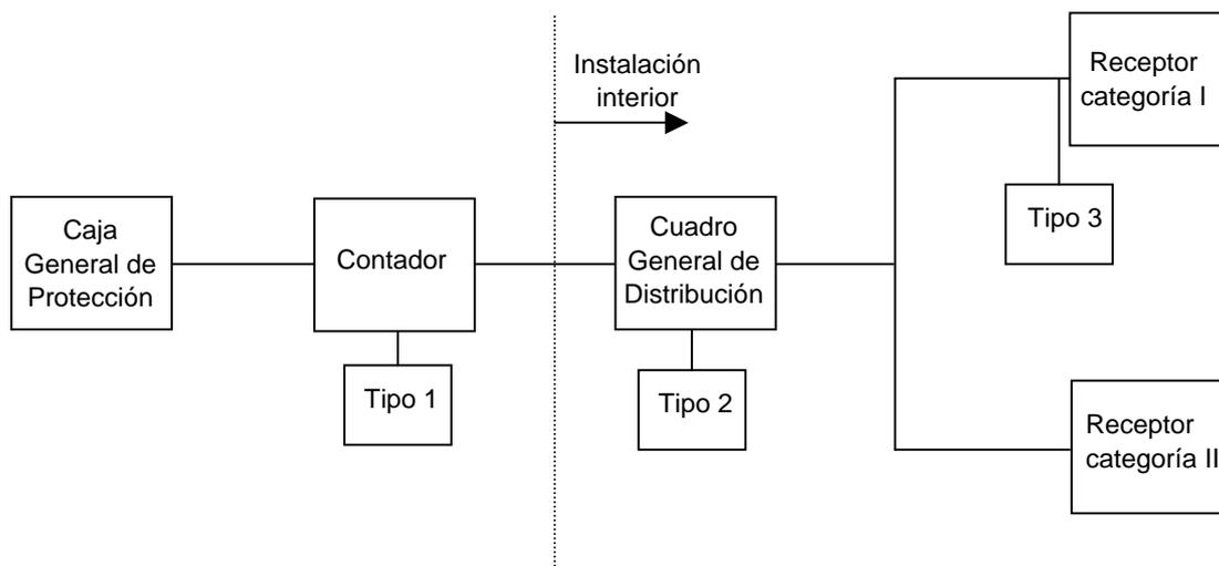
Ejemplo de instalación que incluye los tres tipos de dispositivos de protección contra sobretensiones.
