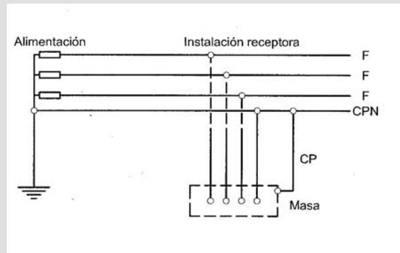
Esquema TN-C-S: En el que las funciones de neutro y protección están combinadas en un solo conductor en una parte del esquema (figura 3).
