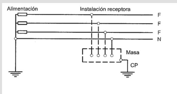
En este esquema las intensidades de defecto fase-masa o fase-tierra pueden tener valores inferiores a los de cortocircuito, pero pueden ser suficientes para provocar la aparición de tensiones peligrosas.
