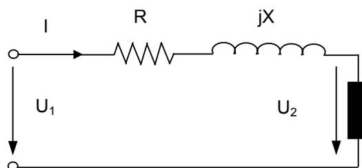
Figura 1. Circuito equivalente de una línea corta.
