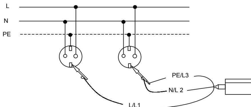
Figura 1. Medida de la resistencia de un conductor de protección.
