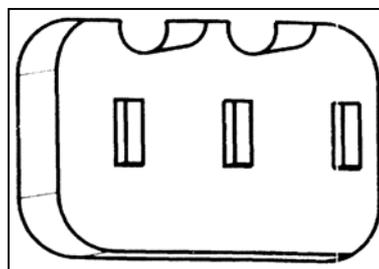
C3a: Base bipolar con espiga de contacto de tierra 10/16A 250V
